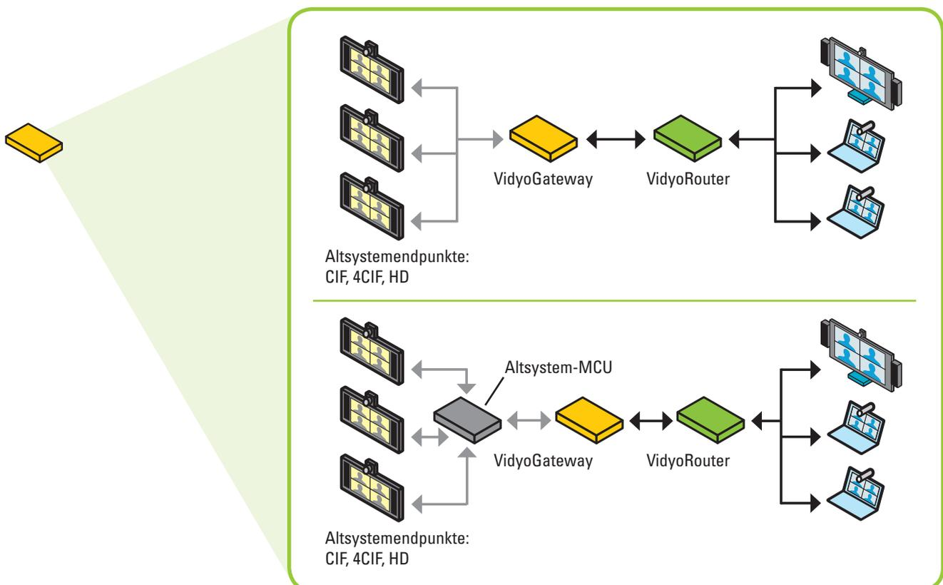
*Ein Altsystemendpunkt an einem VidyoGateway-Port ist vergleichbar mit einem umschlüsselnden MCU-Port.*
